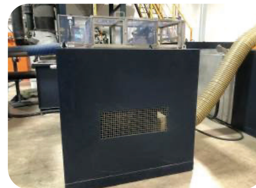
魯式鼓風機增設隔音罩降低噪音
