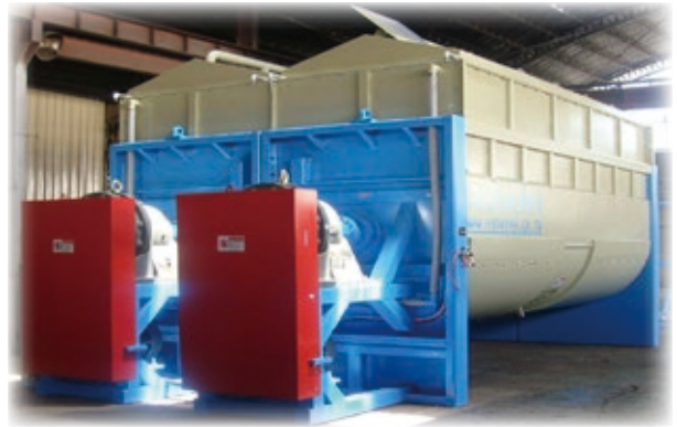
高速發酵堆肥設備
