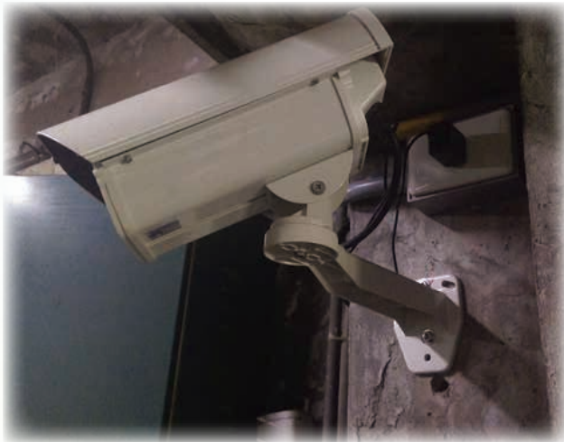
固定汙染源攝影機， 全天候監控排放狀況
